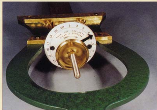
En estas dos fotografías, puede apreciarse el estado inicial y final de la esferilla y rueda de regulación del péndulo, que permite el ajuste continuo y manual de la marcha del reloj.
