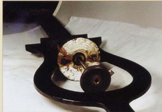
En estas dos fotografías, puede apreciarse el estado inicial y final de la esferilla y rueda de regulación del péndulo, que permite el ajuste continuo y manual de la marcha del reloj.
